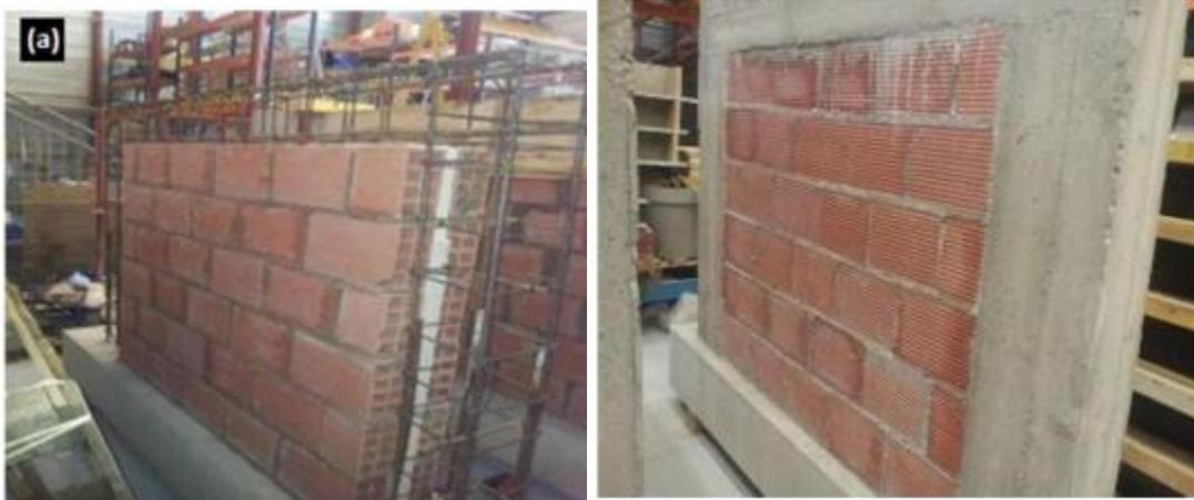
**Fig.III.2. Spécimens avec chaînage uniforme après le décoffrage.**
