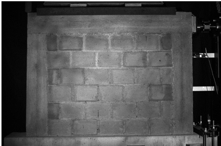
**Fig. III .9 : Test sur le spécimen P2 (chargement cyclique-panneau uniforme).**
