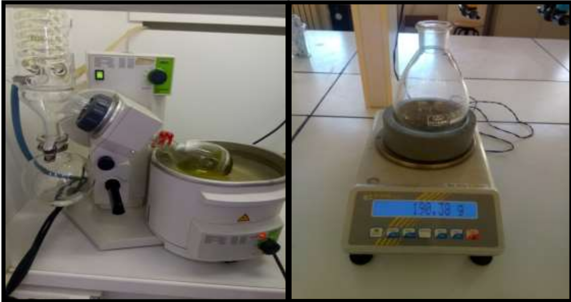
Figure 28 : Evaporation rotative de l'extrait végétale et estimation du poids du résidu sec
