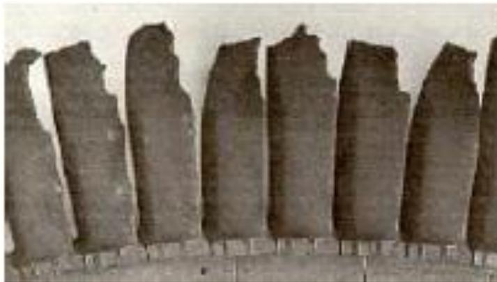
**Figure II.2 :** destruction de l'aube due à la température d'entrée turbine élevée (Rolls Royce 1973).
