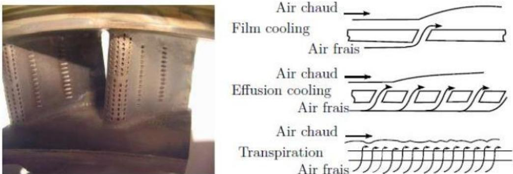
**Figure II-12:** Aube refroidie par film
