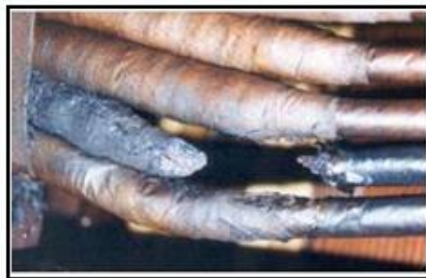
Figure II .6 : Coupure du circuit électrique[3]
