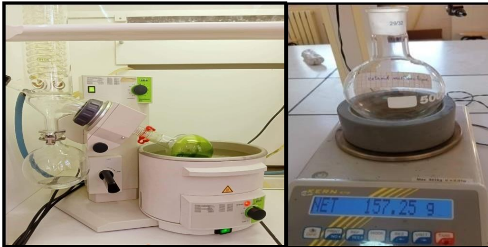
Figure 25 : Evaporation rotative de l'extrait végétale et mesure du poids du résidu sec
