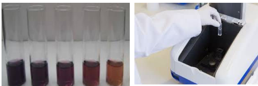
Figure17 : A Préparation des différentes Concentrations et l'ajout de Solution DPPH, B L'appareil de spectrophotomètre UV-Visible
