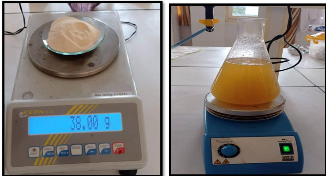
Figure 29 : La préparation du GMH
