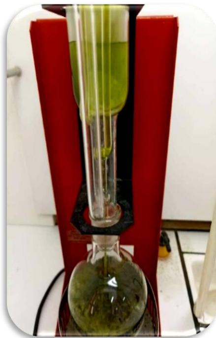
**Figure 62 :** L'appareil de soxhlet
