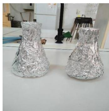
Les erlenmeyers sont mis dans l'agitateur pendant 24h pour la solution aqueuse et 48h pour les solutions méthanoïque et éthanoïque.
