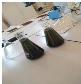
On ferme les erlenmeyers par un parafilm pour éviter l'évaporation des solvants alcooliques et on les couvre par un papier aluminium à l'abri du soleil et l'air.
