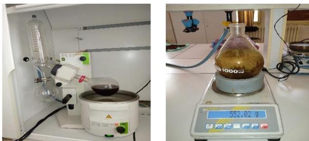
**Figure 11** : évaporation dans le rotavapeur
