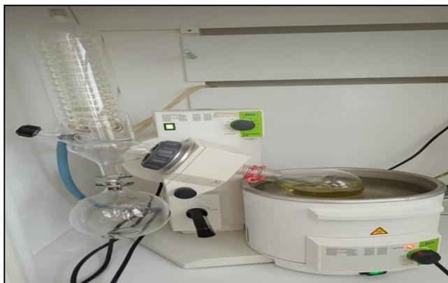
Figure 22: montage de l'évaporateur rotatif de laboratoire (Cliché personnel, 2022)
