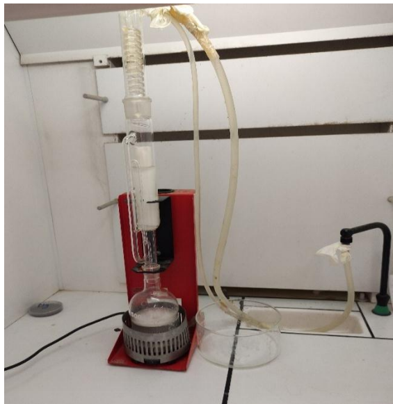
Figure 08 : Extraction de l'huile par soxhlet
