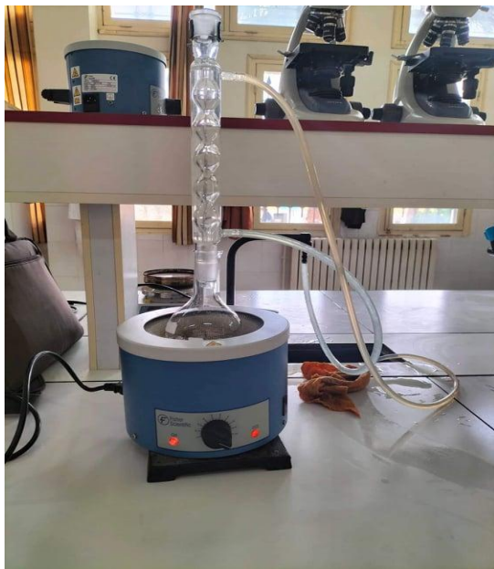
Figure 16 : Ebullition de la solution
