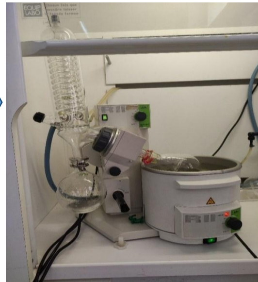
Figure 09 : Evaporation de l'excès de l'hexane par rotavapor
