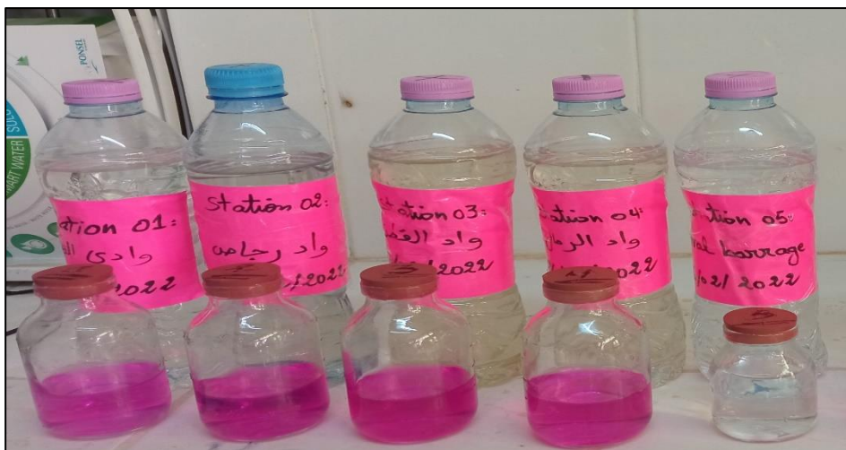
Figure 25 : dosage des nitrates ( \text{NO}_3 ) (Photo originale).
