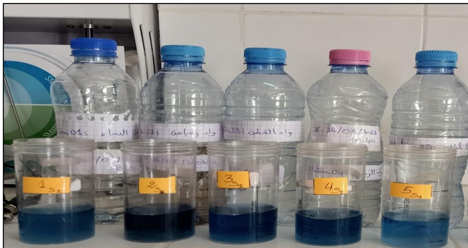
Figure 27 : dosage des phosphates ( \text{PO}_4 ) (Photo originale).
