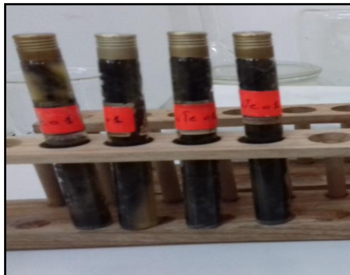
Figure 37 : Résultat de la recherche d'Anaérobies Sulfito-Réducteurs (tubes noir indénombrable) (Avril-mai, 2022).
