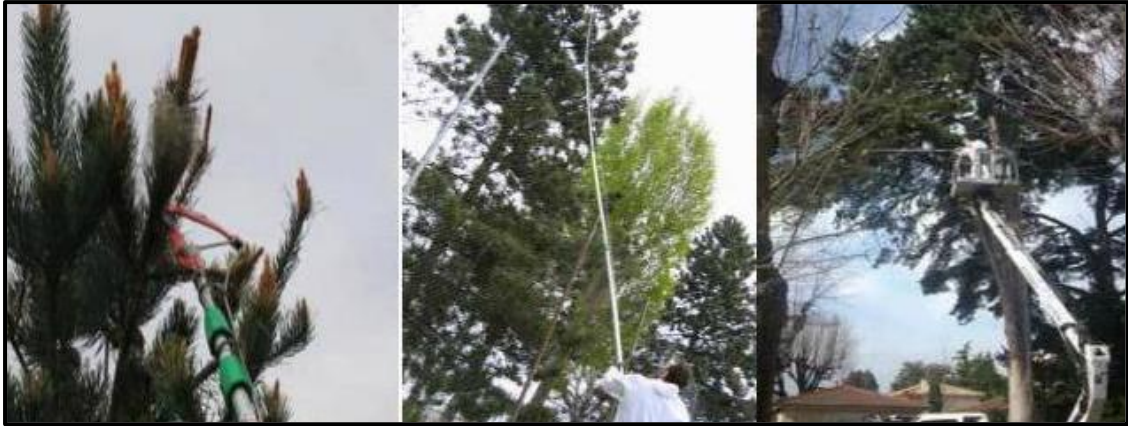
Figure15. Matériel nécessaire à la lutte mécanique : échenilloir à gauche, échenillage à la perche au milieu, échenillage en nacelle à droite ( K3D Lyon Chenilles ).
