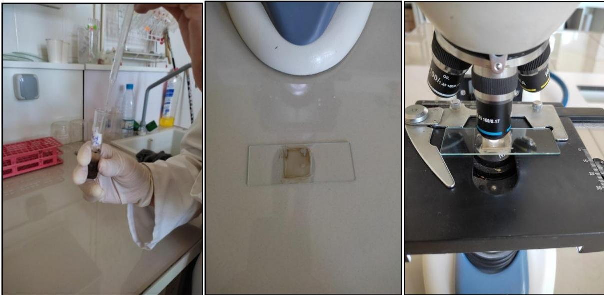
**Figure 38** : Le protocole utilisé pour l'observation microscopique.
