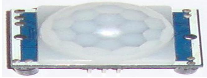
Figure 1.5: Capteur de mouvements
