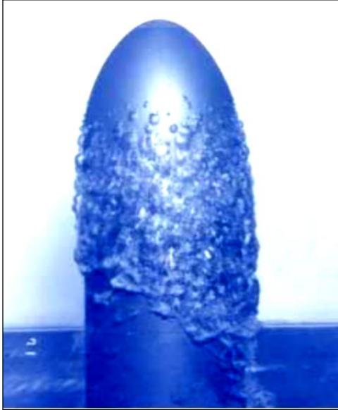
Figure II.3 : Cavitation à poches sur un engin sous-marin.
