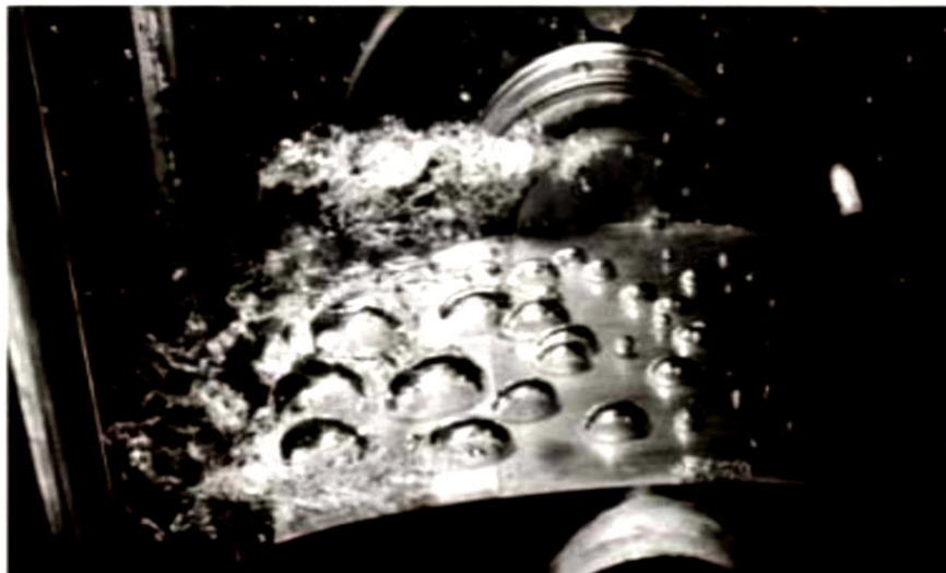
Figure II.2 : Cavitation à bulles sur un profil d'aile.
