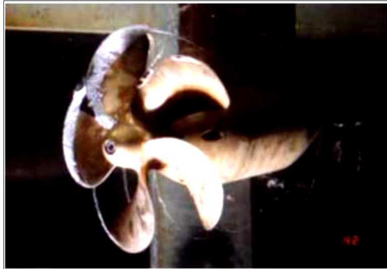
Figure II.5 : Cavitation à lames sur une pale d'hélice.
