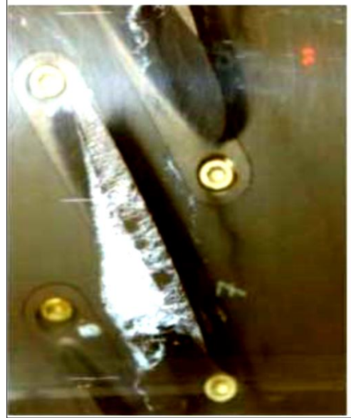
Figure II.4 : cavitation à poches sur un entrefer de roue.
