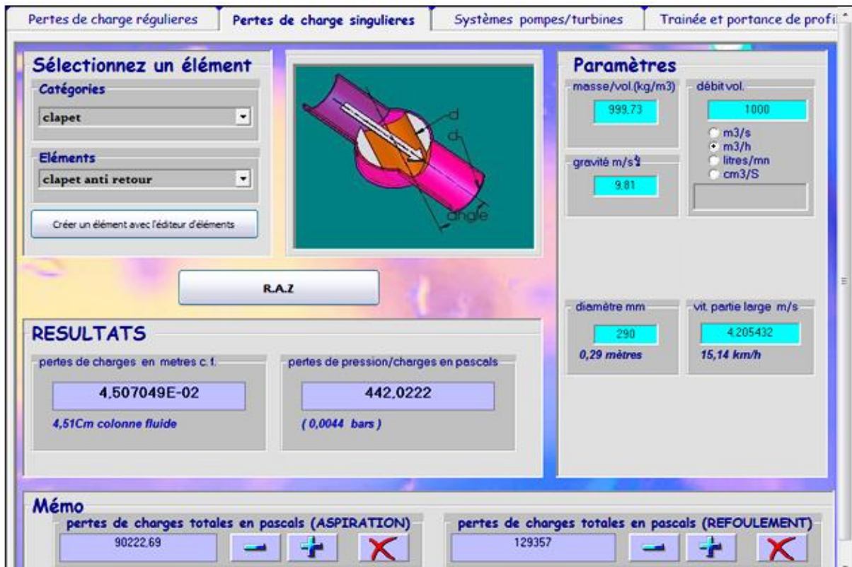
Figure III.15 : Résultats de simulation des pertes de charge singulières dans un clapet anti-retour.
