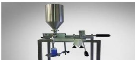
**Figure 3 :** Machine de remplissage manuel [1].
