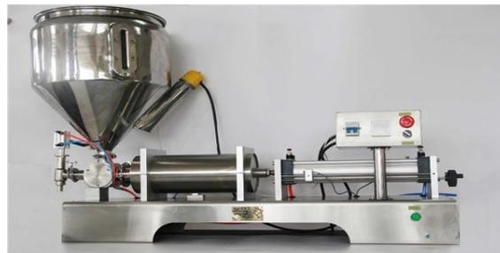
**Figure 2 :** Machine de remplissage semi-automatique [1].
