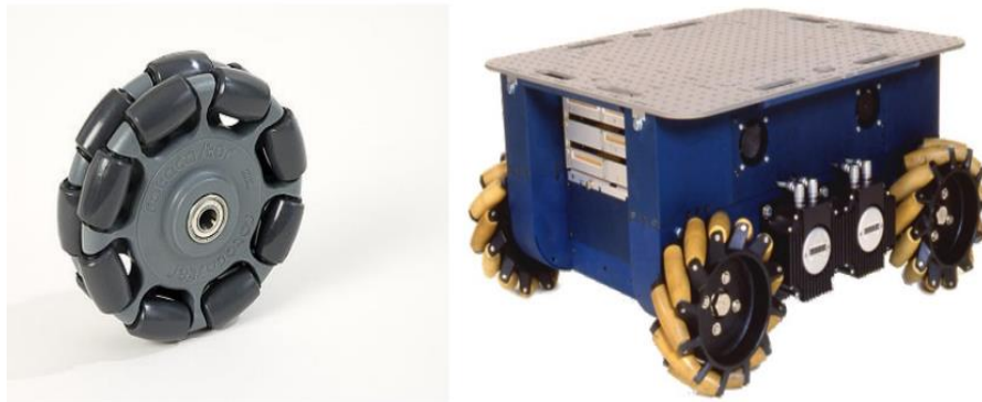
Figure(I.7) : A- Une roue à galets tangentiels (holonomique) ; B- Uranus le robot holonome [12].
