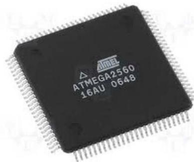
**Figure III.2** : Microcontrôleur ATmega2560.
