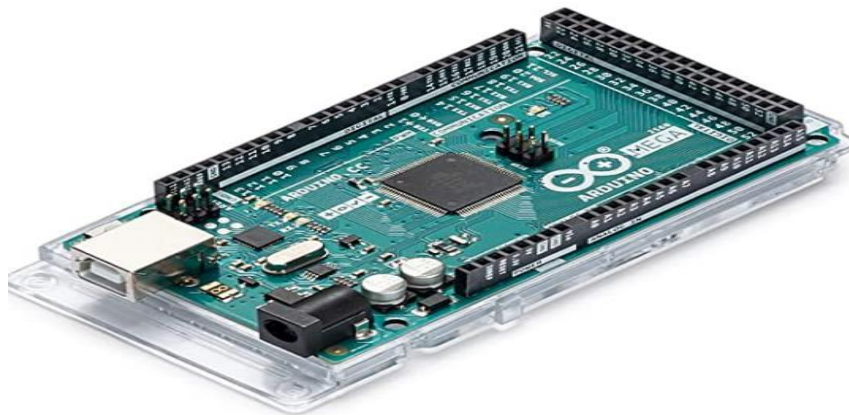
Figure2.2 : La carte Arduino Mega 2560
