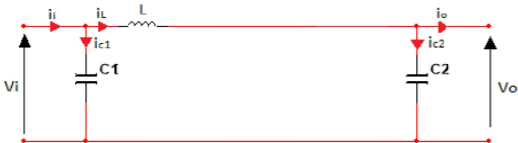
**Figure III.7 :** le schéma équivalent de convertisseur DC-DC de type BOOST l'interrupteur K est ouvert
