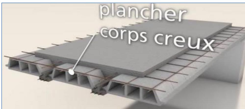
**Figure III.1** : Les éléments principaux d'un plancher à corps creux
