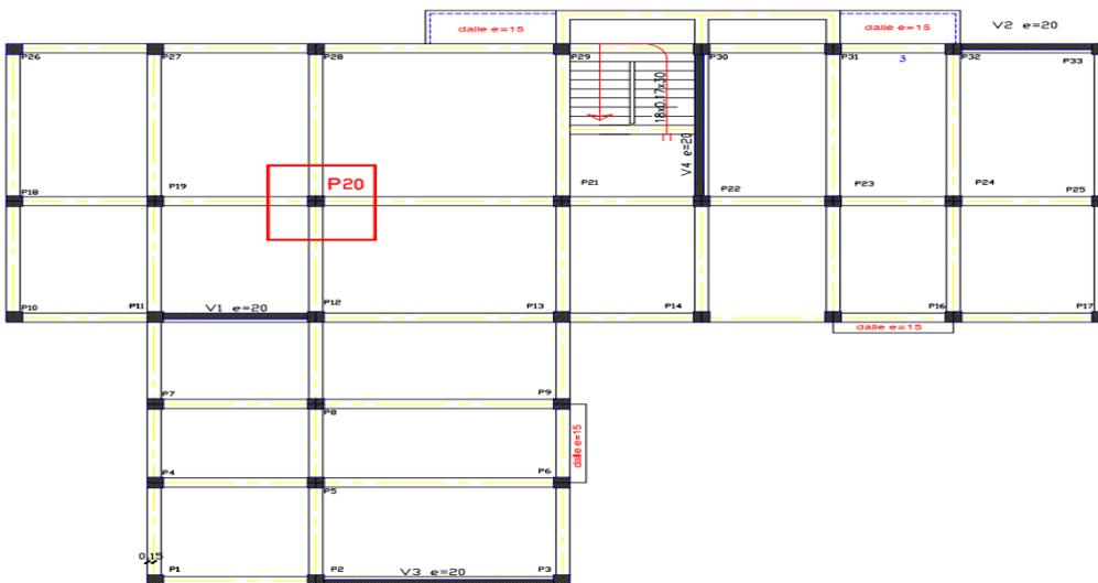
**Figure III.21:** Emplacement du poteau le plus sollicité (sur la plan )
