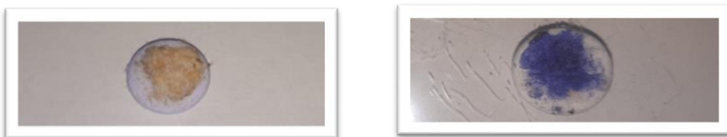
Figure 37. Test Oxydase, à gauche négatif, à droite positif (Cliché personnel, juillet 2021)
