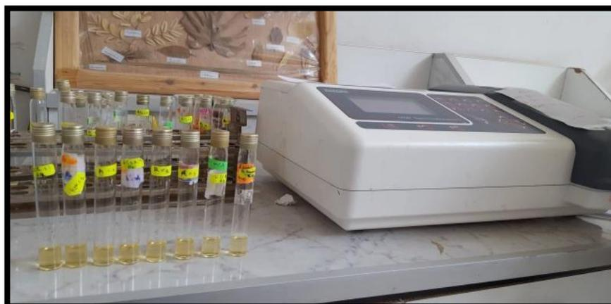
**Figure 28:** Lecture de l'absorbance sur Spectrophotomètre a 695 nm.
