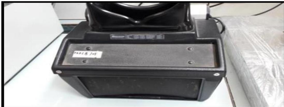
**Figure 27** : Révélation des plaques sous une lampe UV à la longueur d'onde 254 et 366 nm
