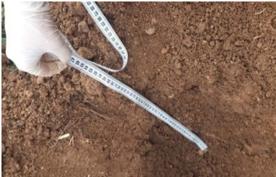
Figure 17 : La profondeur des cubes de terre
