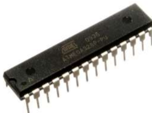
Figure II-8: Un microcontrôleur ATmega328 tout seul.[38]
