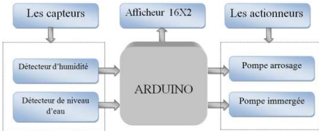
Figure III-18:Schéma synoptique du système d'irrigation automatisé
