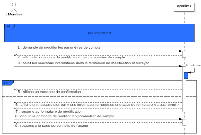
Figure III.12 : Le diagramme de séquence de cas « Modifier les paramètres de compte ».
