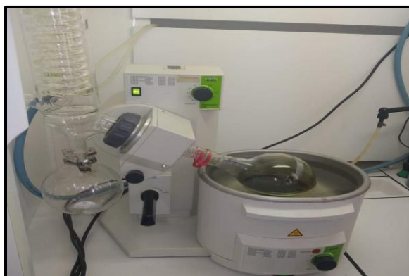
Figure 19 : Evaporation de l'extrait hydrométhanolique
