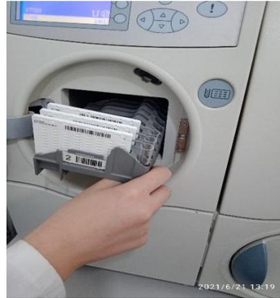
**Figure 21:** chargement de la chambre d'inoculation.
