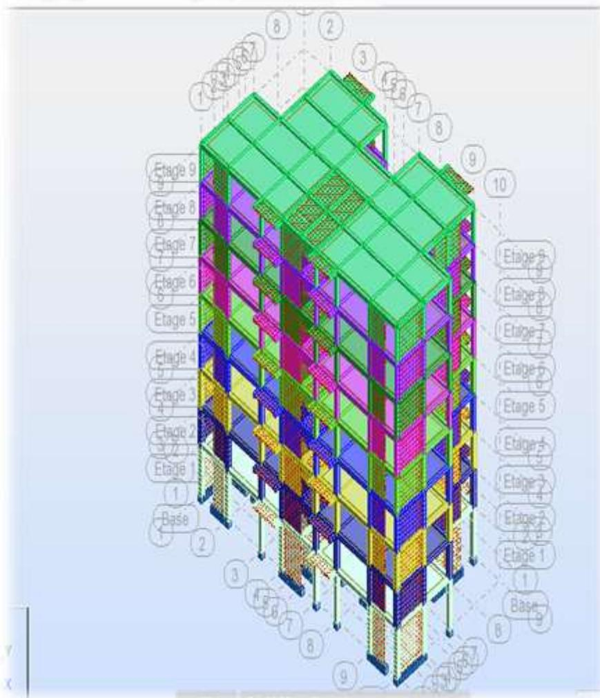
Figure IV.1 : Vue en 3D de la modélisation de la structure avec le logiciel Robot.
