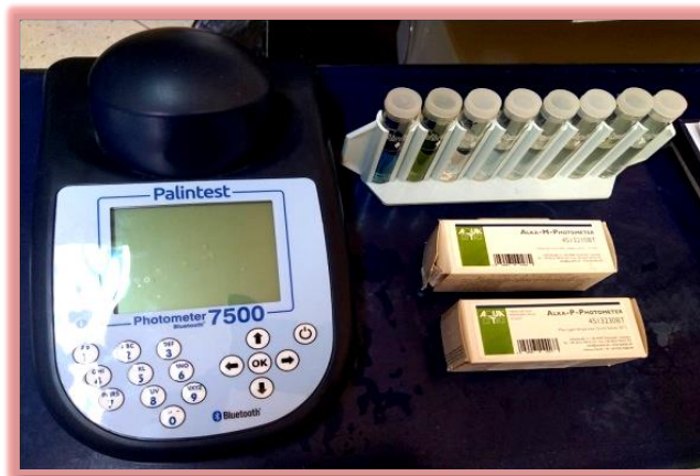
Figure 23 : Appareil de Palintestphotomètre 7500 (Multivarie) et les pastilles d'Alka-M-, Alka-P-photomètre.
